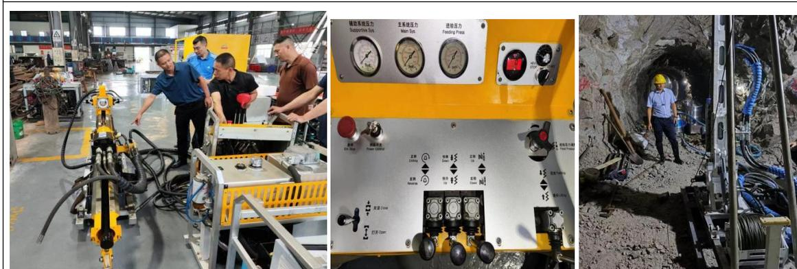
图 2-7 电动液压钻机自动控制系统应用于深长隧道作业测试
